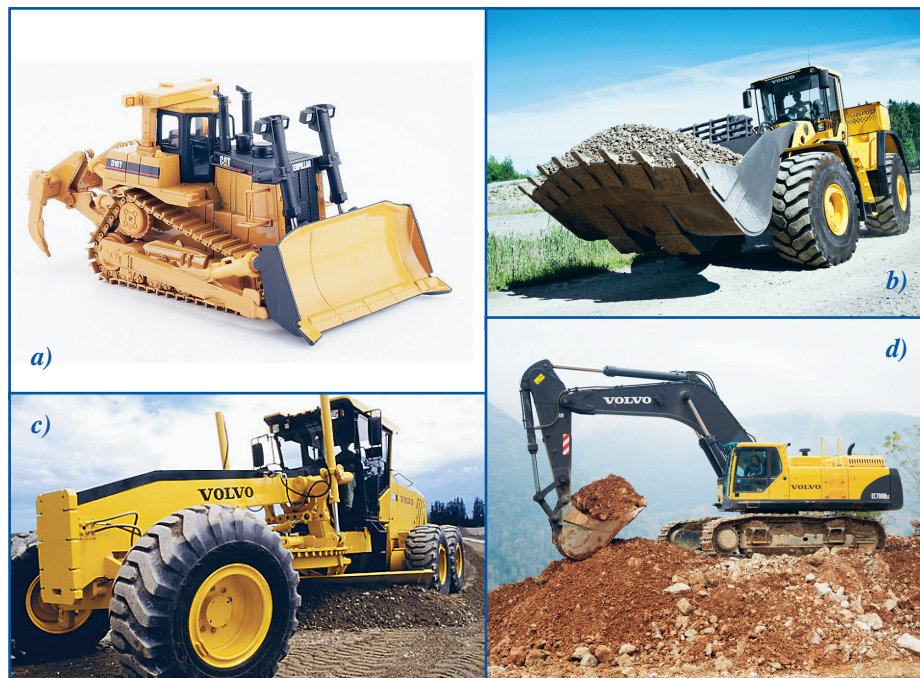
Figur 5: Ur klassificeringsperspektiv är det intressant att dela upp maskinerna i maskiner utrustad med skopa eller blad: a) Schaktare med blad. b) Lastare med skopa. c) Hyvel med blad. d) Grävare med skopa.
